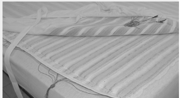
MATRASOVERTREK met geïntegreerde matrix van druksensoren om bewegingen (met inbegrip van de hartslag) te registreren.
