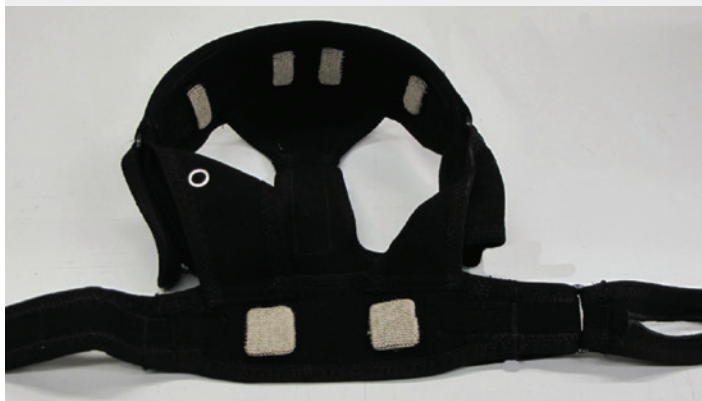
HOOFDBAND de sensoren op het voorhoofd meten de oogbewegingen en hersengolven (elektro-encefalogram (EEG))
