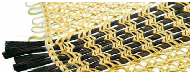
tricot verre/aramide à trame de fibres de carbone (Tec-Knit)
