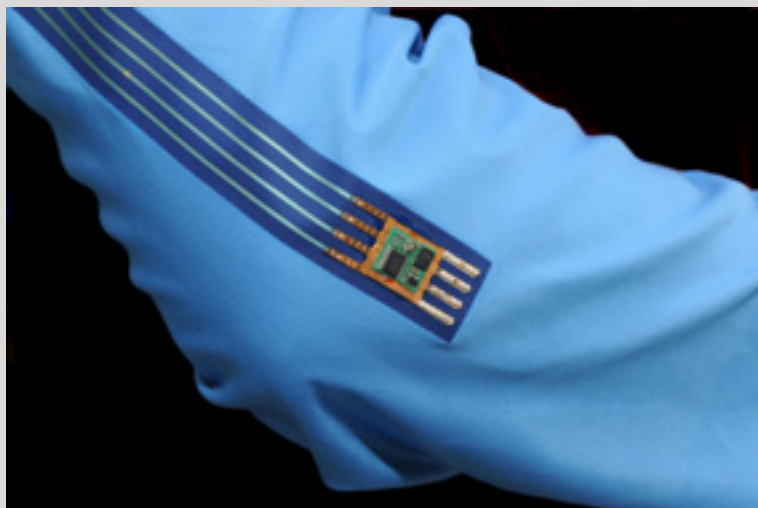
L'électronique imprimée relie le capteur textile à la batterie amovible [SmartPro]
