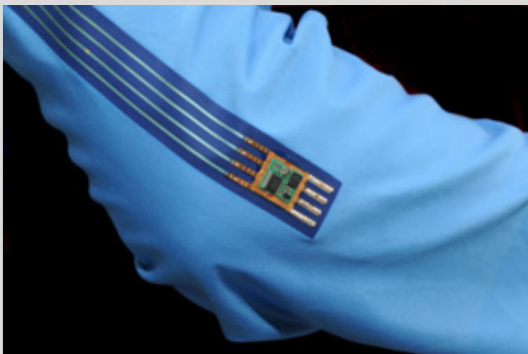
Geprinte elektronica verbindt de textielsensor met afneembare batterijmodule [SmartPro]
