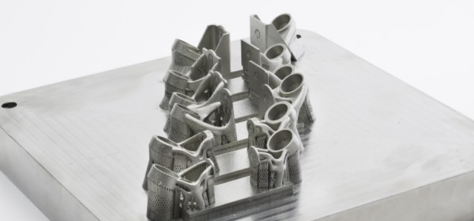
3D geprint remsysteem voor vliegtuigen door Sintavia - a leading metals additive manufacturing company
