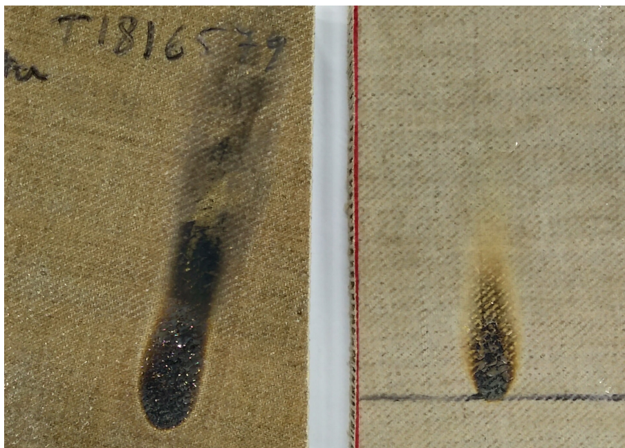
Panneaux composites dotés d'une peau composée d'une résine à base de lin réticulable par UV, sans (à gauche) et avec retardateur de flammes (à droite).
