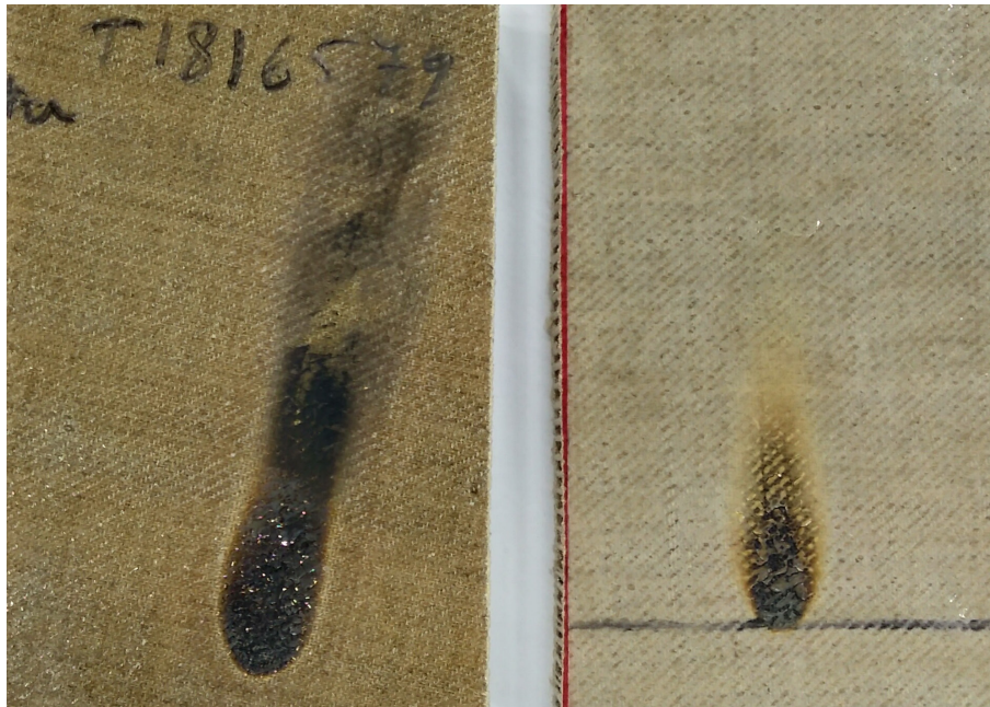
Composietpanelen met een vlas-UV uithardbaar hars als huidlaag zonder (links) en met brandvertrager (rechts). Testmethode EN ISO 11925-2.
