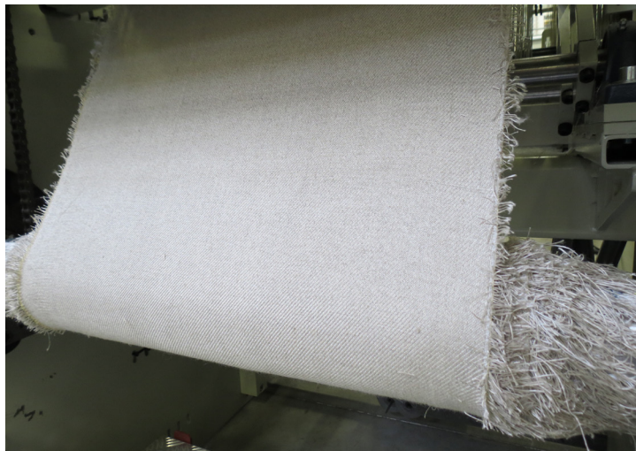
à gauche : tissu croisé 2-2 en 100% lin - à droite: tissu hybride lin/PLA réalisés dans le cadre du projet Feder Macobio - développement de composites biosourcés
