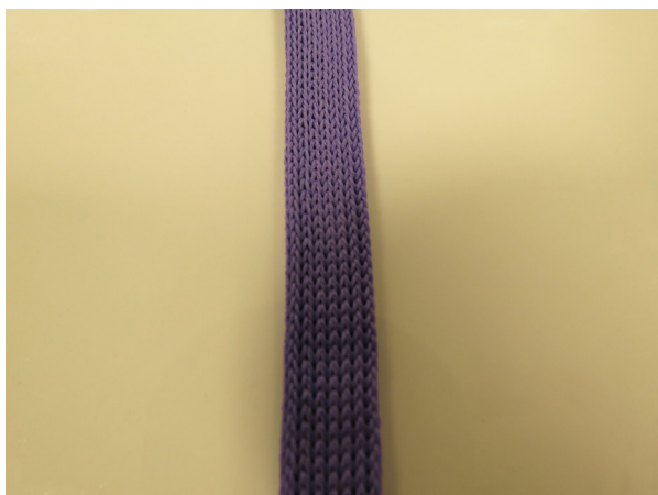
2D kettingbreisel gemaakt uit bioresorbabeerbare multifilamenten als ondersteunend element voor weefselcultuur
