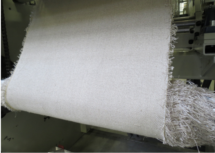
Linksboven: keperweefsel 100% vlas - Rechtsboven: hybrideweefsel vlas/PLA als weefselversterking voor composieten in het kader van het Macobioproject
