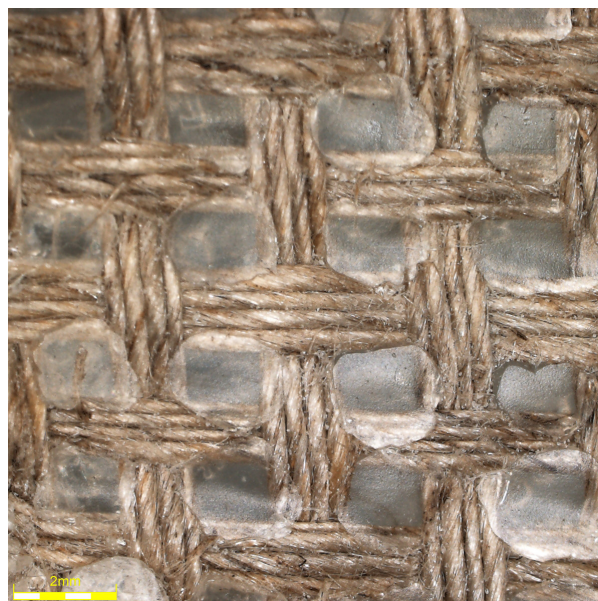
Flexibele PLA coating van 150 \mu\text{m} dik op vlasweefsel aangebracht via rakelcoating (links) en via hotmelt coating (rechts) op een open weefstructuur
