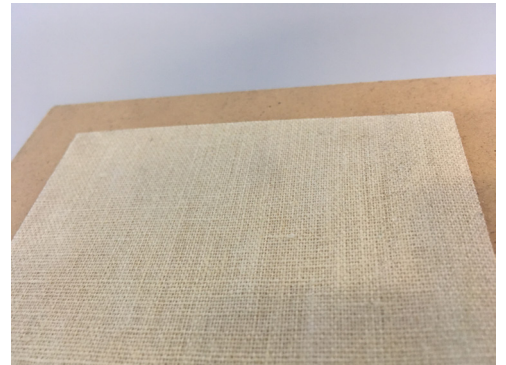
Linnen gelamineerd op een houtvezelplaat met behulp van een PLA coating
