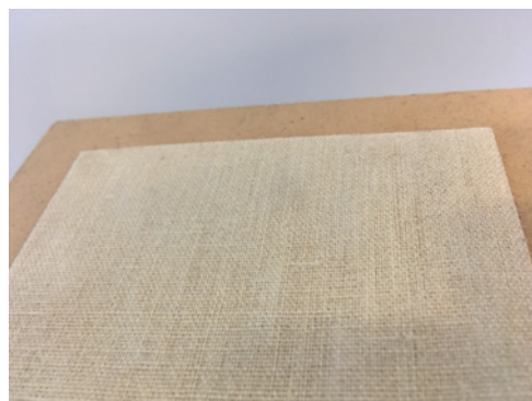
Lin laminé sur un panneau de fibres de bois à l'aide d'une enduction à base de PLA
