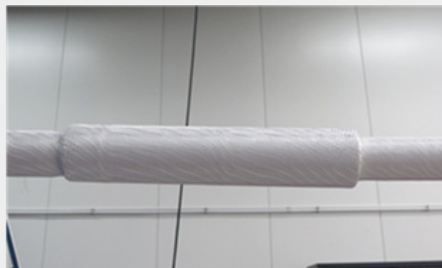
Tresse en fibre de verre sur support de forme variable
