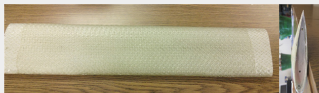
Profiel van een windmolenpropeller in glasvezel
