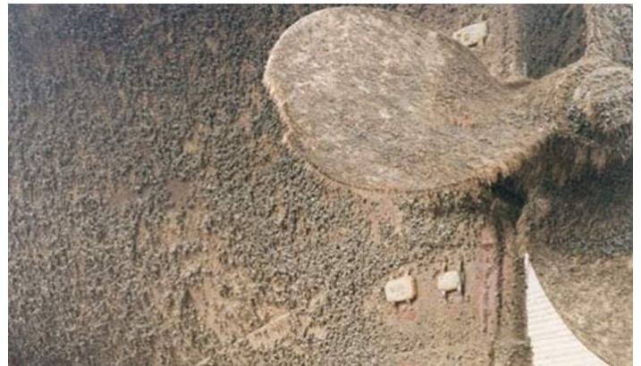
Fouling van een scheepsroer
