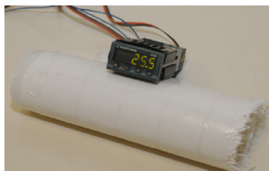
Tissu thermo-réactif doté d'un capteur électronique intégré
