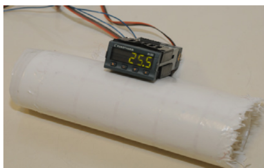
Temperatuur-responsief weefsel met geïntegreerde elektronische sensor
