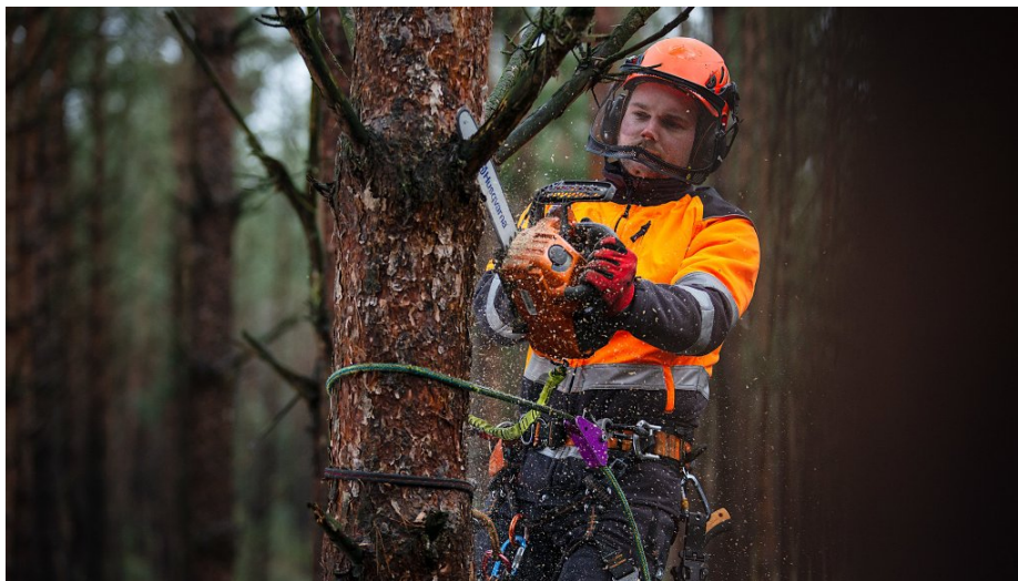
Bosbouwers dragen speciale broeken en vesten die hen beschermen tegen ontsprende kettingzagen. Daarvoor wordt een PFAS-stof gebruikt.
