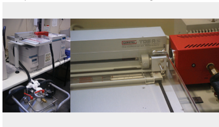
Fig. 2: Absorption thermique par échantillonnage Tenax TA vers GCMS
