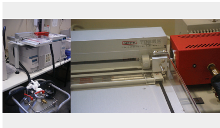
Afb. 2: thermische absorptie met Tenax TA bemonstering naar GCMS
