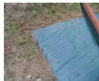
Geweven PLA tapes als geotexiel Bonar (BE)
