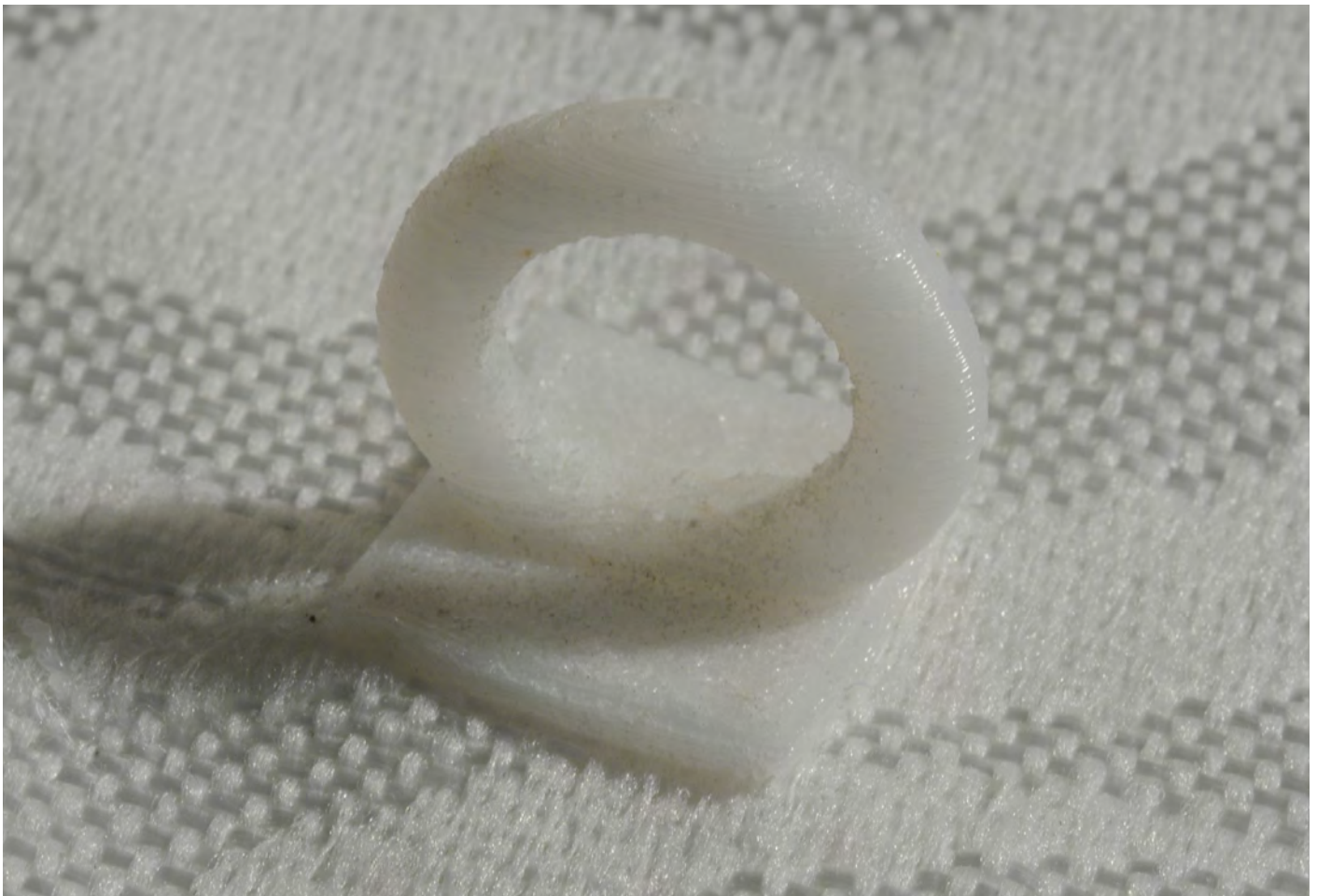
Ring rechstreeks op textiel aangebracht via 3D printing
