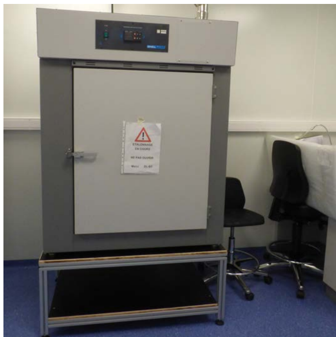
Four pour prétraitement des assemblages avant test virus (pompiers) Oven voor het voorbehandelen van brandweerpakken - virustest
