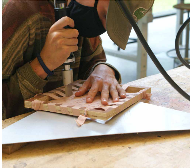
→ Eén van de vele prille experimenten: verweven in uitgerokken toestand in combinatie met ultrasoonlassen als fixatietest.
