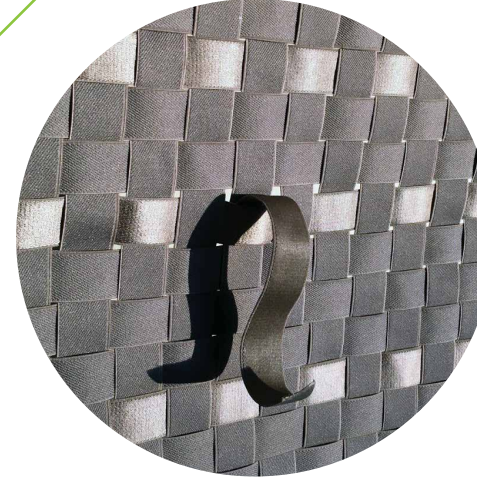
→ Dankzij een verweven structuur en met een backing van gelijksoortig PA-plaatmateriaal, is via ultrasoonlassen een decoratieve plaat verkregen die qua materiaal niet minder zuiver geworden is dan oorspronkelijk.
