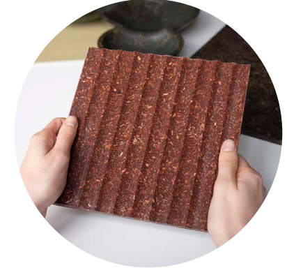
→ Een geperste composietplaat vervaardigd uit biomassa afkomstig van planten.
