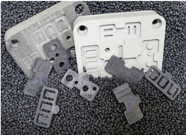
→ Testresultaten gerealiseerd in een hybride matrijs met aluminium gevulde polyurethaan
