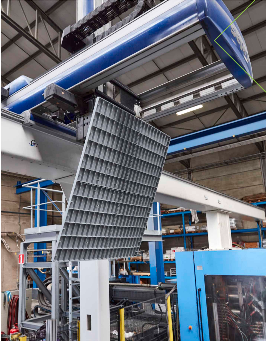
→ Kunststofpanelen via spuitgieten vervaardigd bij Paneltim .
