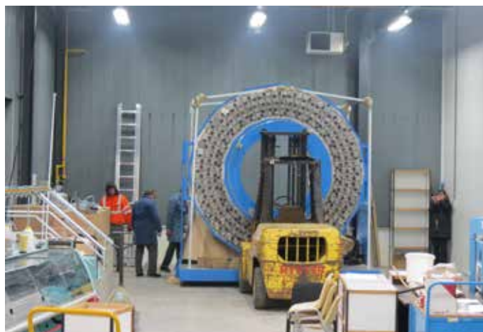
Installation de la tresseuse à Centexbel Verviers
