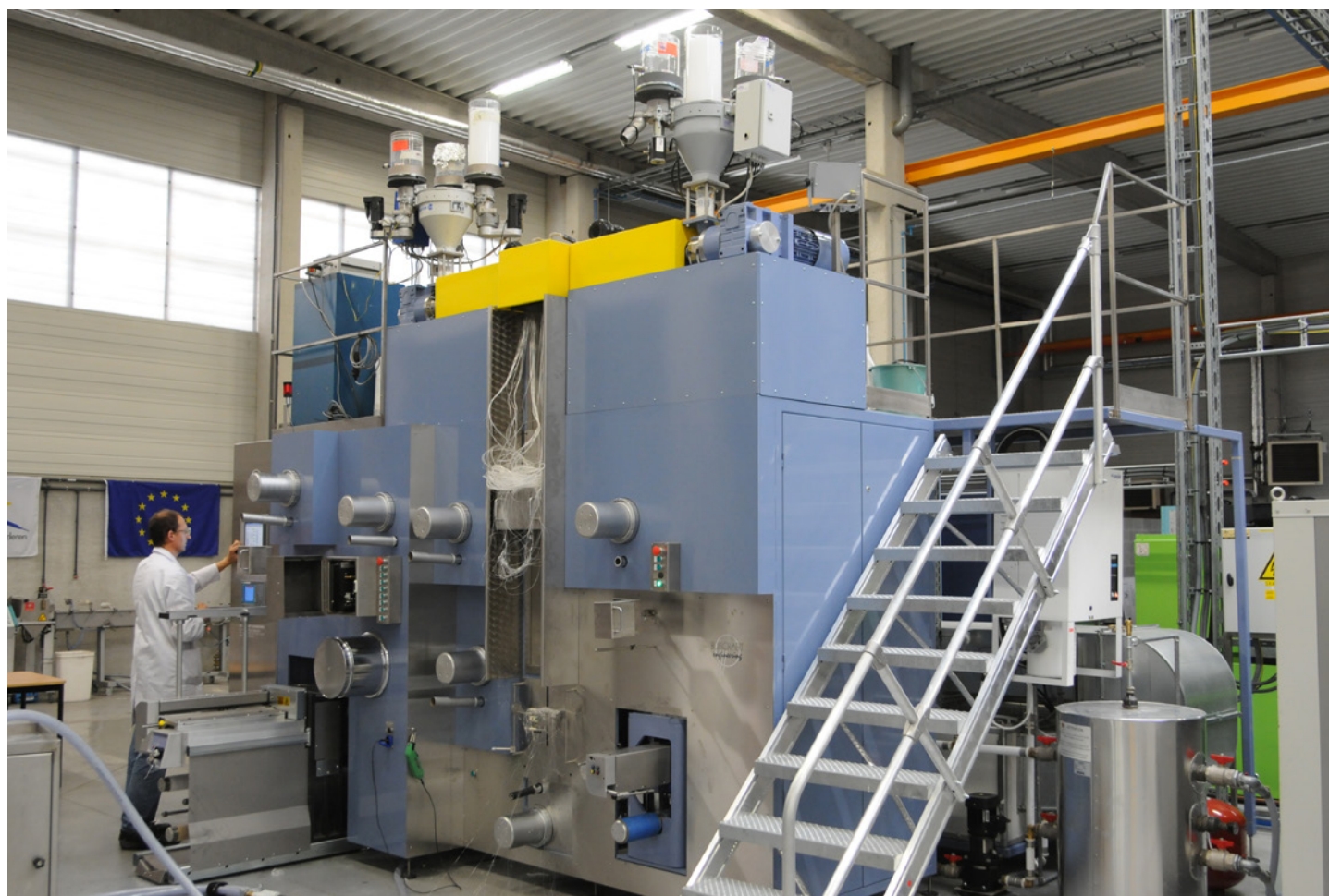
ligne multifilaments pour l'extrusion de BCF, CF et POY : le SPINMASTER
