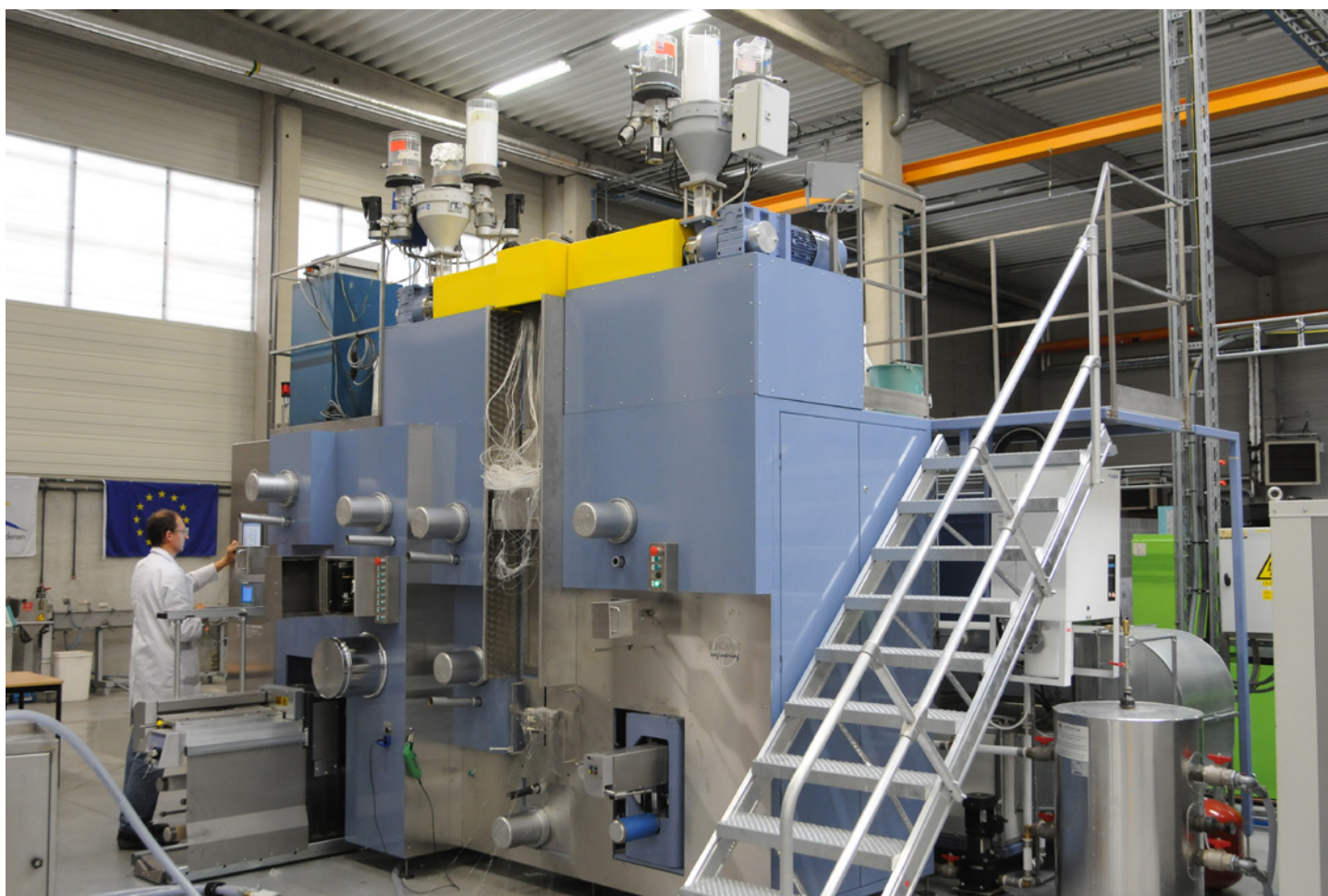
multifilamentlijn voor BCF, CF en POY: de SPINMASTER
