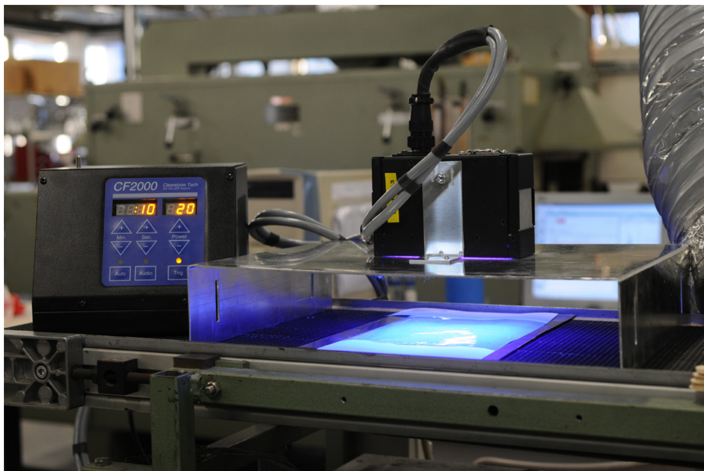
UV-LED installatie voor het uitharden van coatinglagen
